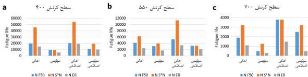
شکل ۱۰. نتایج عمر خستگی مخلوط‌های آسفالتی بر اساس سه معیار N_{F50} ، N_{S*N} و N_{ER}
