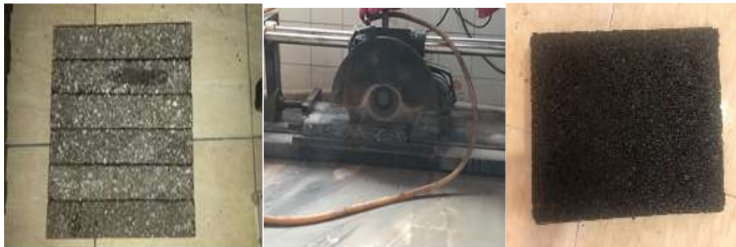
شکل ۳. مراحل ساخت تیرچه‌های مخلوط آسفالتی نیمه‌گرم ✓
