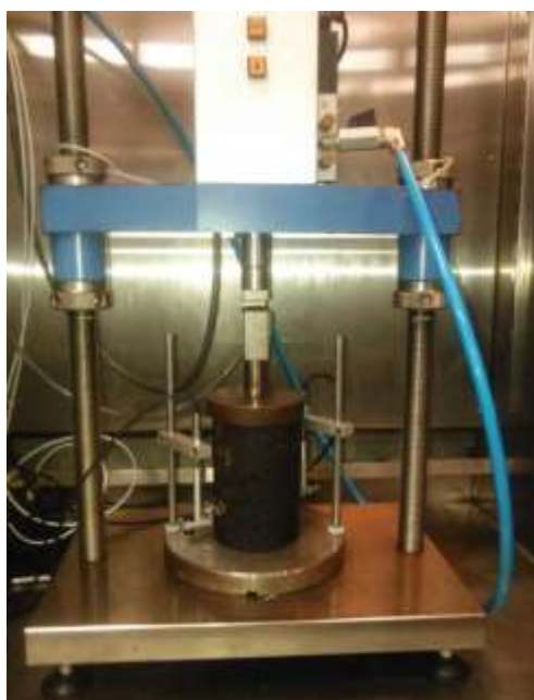
شکل ۳. نمونه استوانه‌ای در حین انجام آزمایش مدول دینامیک
