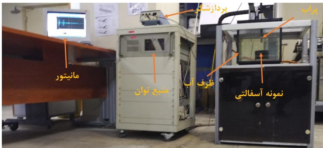
شکل ۴. دستگاه اندازه‌گیری مدول طولی با امواج التراسونیک
