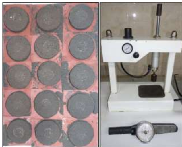
شکل ۲. نمایی از دستگاه آزمایش چسبندگی و نمونه ها بعد از آزمایش
