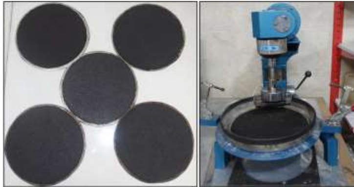
شکل ۳. نمایی از دستگاه آزمایش WTAT و نمونه‌های آن
