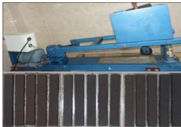
شکل ۴. دستگاه چرخ بارگذاری - ارزیابی جابه‌جایی و نمونه‌های آن
