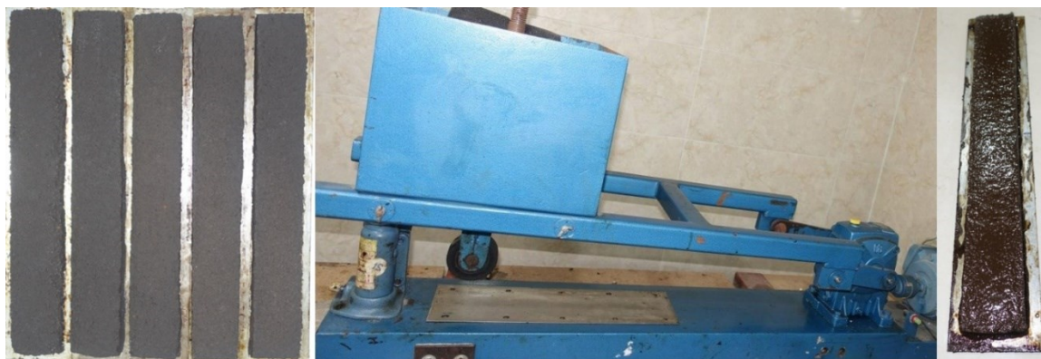
شکل ۳. دستگاه آزمایش چرخ بارگذاری و نمونه‌های آن
