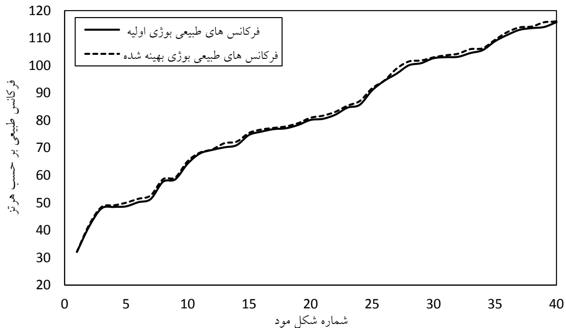
شکل ۱۸. مقدار فرکانس طبیعی در شکل مودهای مختلف فریم بوژی اولیه و بهینه شده تحت بار ۲۲/۵ تن
