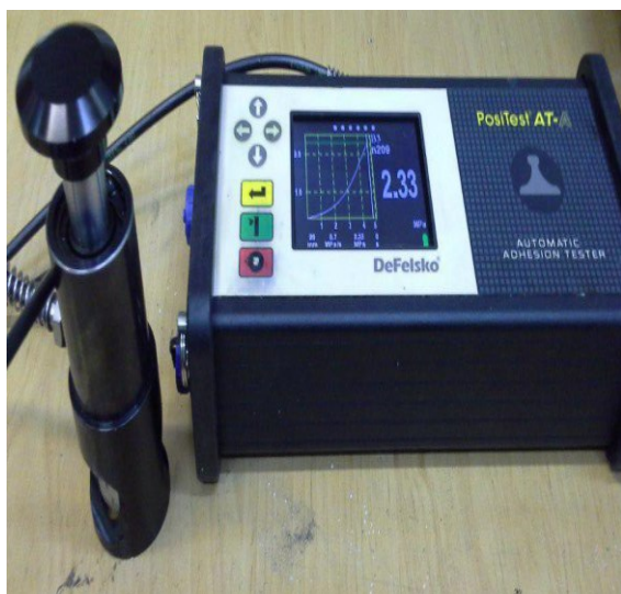
شکل ۳. قرارگیری نمونه‌ها در آزمایش Pull Off
