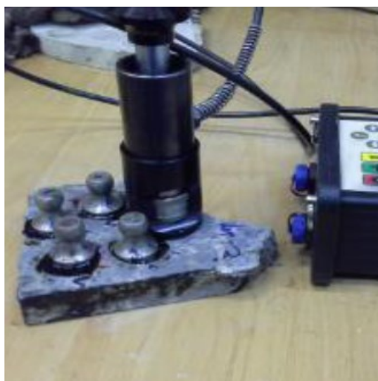
شکل ۳. قرارگیری نمونه‌ها در آزمایش Pull Off
