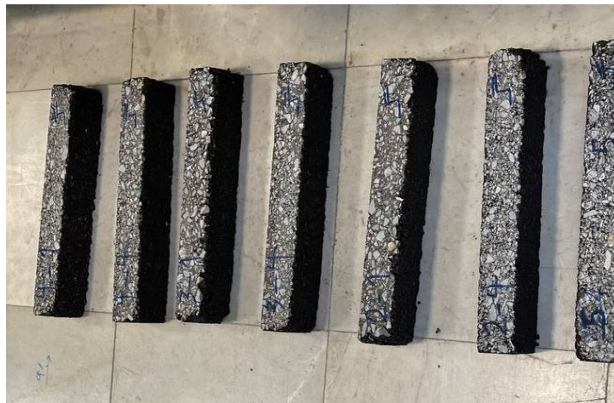
شکل ۴. تیرچه‌های آزمایش خستگی
