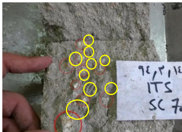
شکل ۴. صفحه شکست نمونه تثبیت شده بدون الیاف
