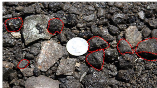
شکل ۸. گوشه‌دار و درشت‌دانه بودن مصالح آسفالتی
