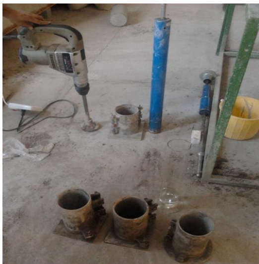
شکل ۱۱. تراکم نمونه‌ها با استفاده از تراکم لرزه‌ای
