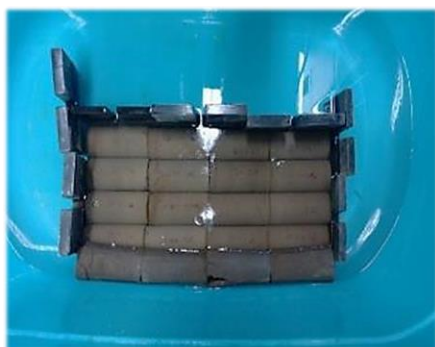
شکل ۶. نمونه‌های ساخته شده در ابعاد ۱۰×۵ سانتی‌متری و نمونه‌های غرقاب شده
