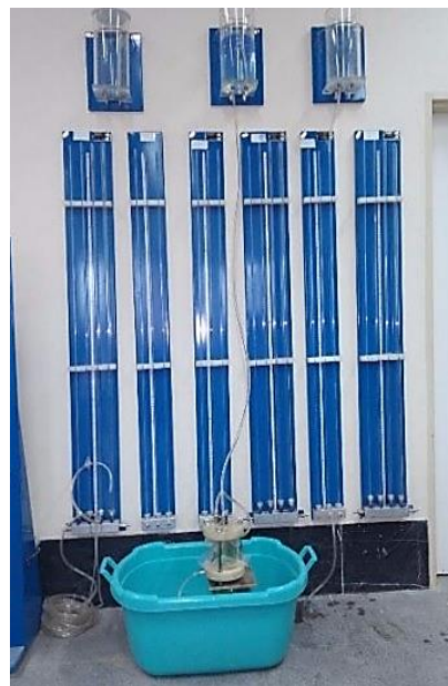
شکل ۷. آزمایش نفوذپذیری منطبق بر روش بار افتان
