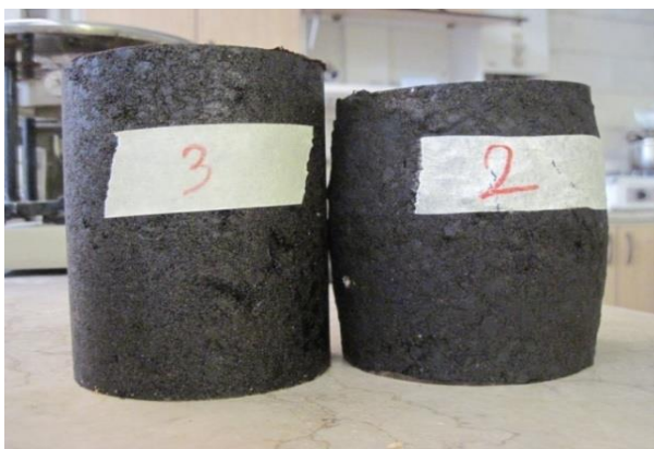
شکل ۳. آماده‌سازی نمونه آسفالت با روکش غشاء آب‌بند. شکل ۴. مقایسه ظاهری ابعاد نمونه قبل و بعد از انجام آزمون
