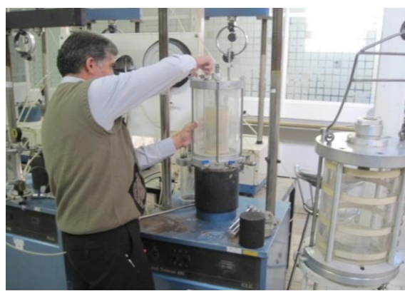
شکل ۳. آماده‌سازی نمونه آسفالت با روکش غشاء آب‌بند. شکل ۴. مقایسه ظاهری ابعاد نمونه قبل و بعد از انجام آزمون
