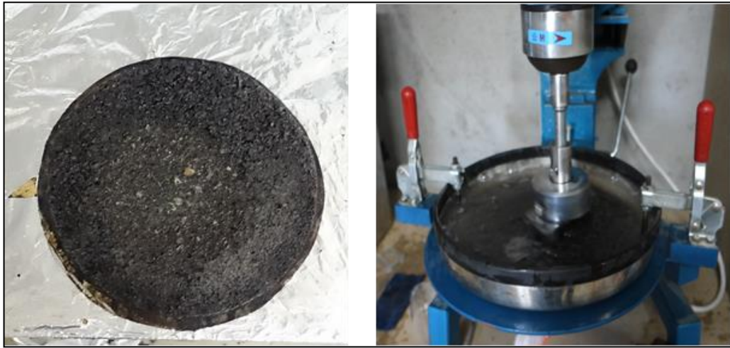
شکل ۵. نمایی از دستگاه آزمایش WTAT و نمونه آن بعد از اعمال سایش
