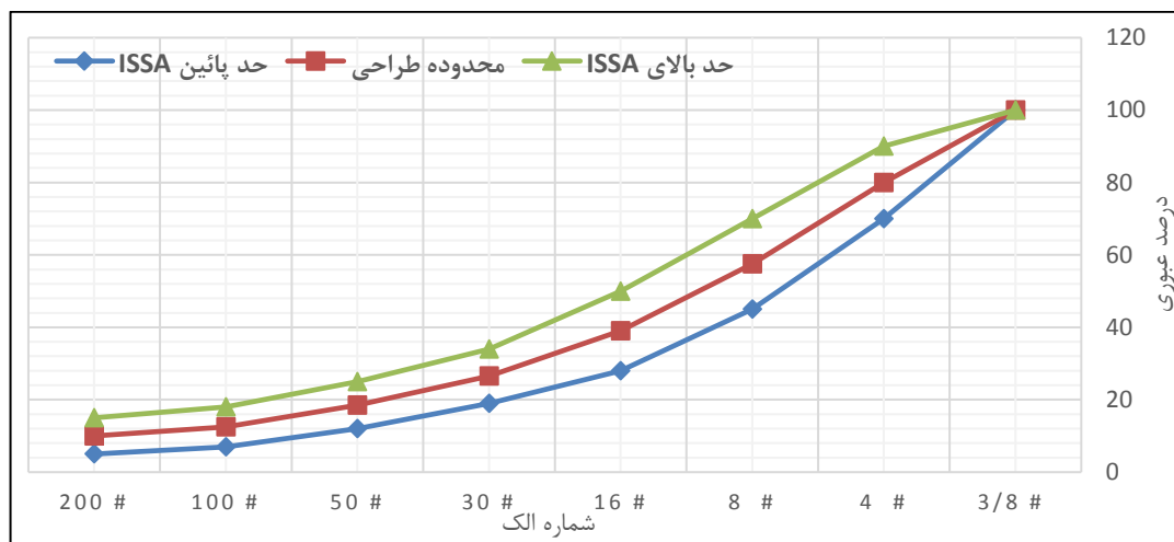
شکل ۱. محدوده دانه‌بندی نوع III مورد استفاده در پژوهش مطابق با استاندارد ISSA A143
