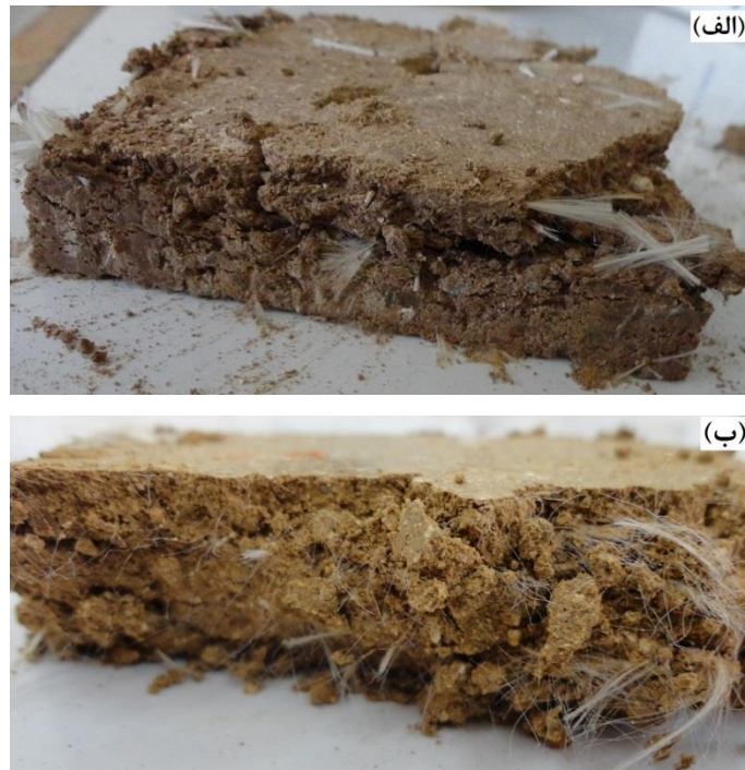
شکل ۶. نمونه‌ی مورد آزمایش مسلح با ۲٪ درصد الیاف: الف) الیاف شیشه و ب) الیاف پلی‌پروپیلن
