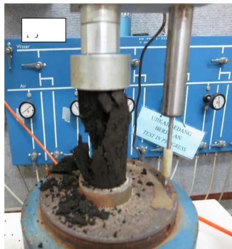
شکل ۳. آزمایش تک‌محوری: الف) در حین آزمایش و ب) پس از گسیختگی
