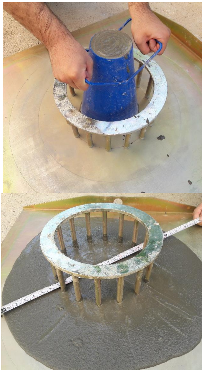
شکل ۵. نحوه انجام آزمایش J-ring
