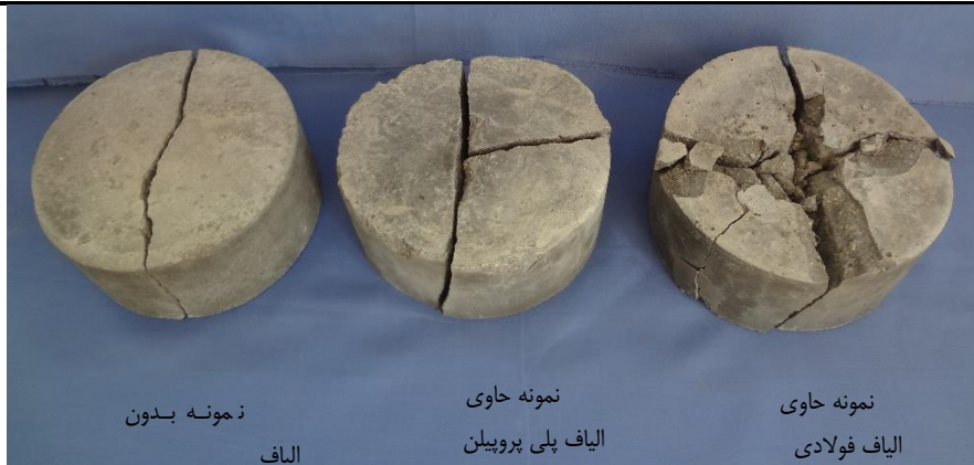
شکل ۹. نمونه‌ای از نتایج آزمایش ضربه وزنه افتان
