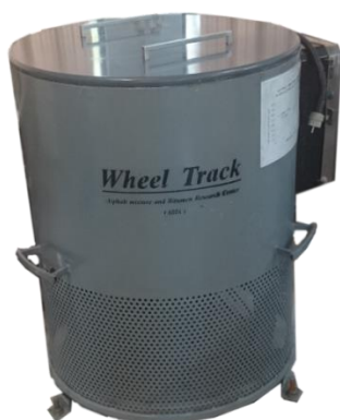
شکل ۶. دستگاه ویل ترک ساخته شده در مرکز تحقیقات قیر و مخلوطهای آسفالتی
