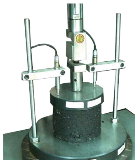
شکل ۵. فک دستگاه UTM5 مربوط به آزمایش خزش
