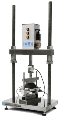
شکل ۳. فک دستگاه UTM5 مربوط به آزمایش مدول برجهندگی
