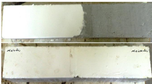
شکل ۱۲. نحوه‌ی اجرای رنگ بر سطوح بتنی
