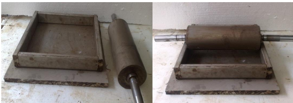
شکل ۲. قالب و غلتک تراکم
