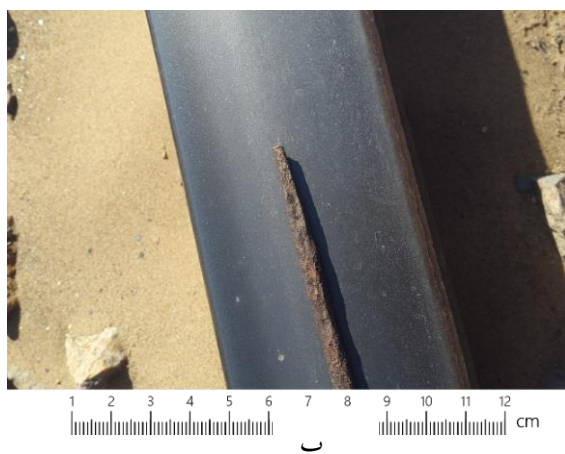
شکل ۶. خوردگی شدید فولاد پیش‌تنیده در یک تراورس تخریب شده
