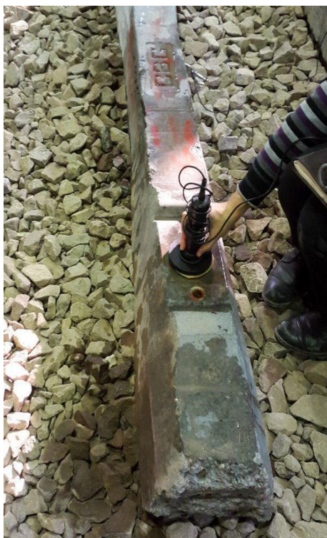
شکل ۱۵. انجام تست شدت خوردگی روی تراورس ها با دستگاه GalvaPulse
