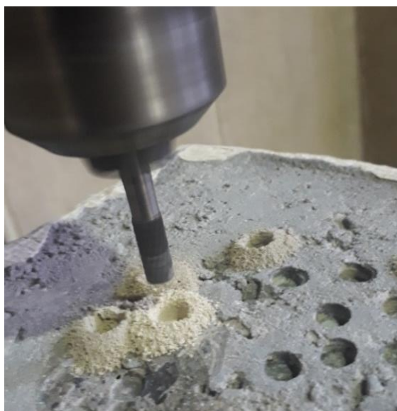
شکل ۱۷. نمونه برداری از نمونه مکعبی
