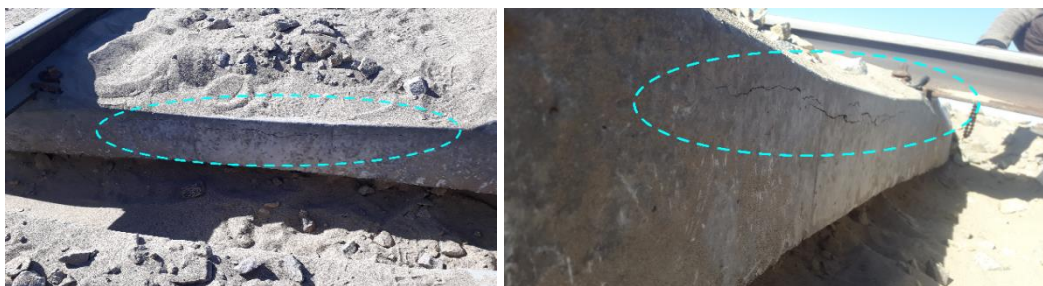
شکل ۷. ترک طولی در الف تار بالایی تاندون‌ها در مرکز تراورس ب
