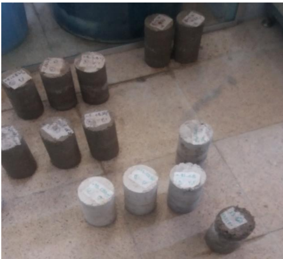
شکل ۲. نمونه‌های استوانه‌ای ساخته شده
