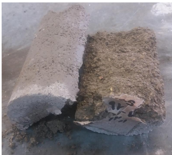
شکل ۶. نمونه استوانه‌ای بعد از آزمایش مقاومت کششی دو نیم شدن
