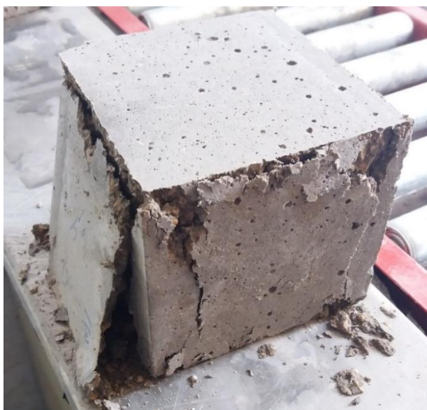
(ب) نمونه مکعبی بعد از آزمایش مقاومت فشاری
