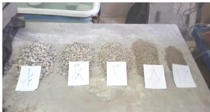
شکل ۱. نمونه مصالح سنگی مورد استفاده در ساخت بتن
