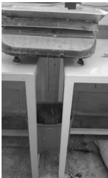
شکل ۷. نحوه انجام آزمایش درصد تخلخل
