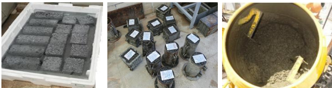
شکل ۴. الف) مخلوط کن بتن، ب) ساخت نمونه‌های بتن متخلخل و ج) عمل‌آوری نمونه‌ها
