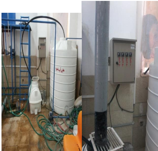
شکل ۶- الف) نحوه آب‌بندی کردن نمونه (آزمایش نفوذپذیری) ب) نحوه انجام آزمایش نفوذپذیری با هد ثابت
