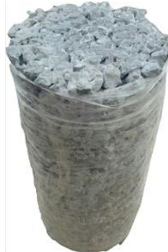
شکل ۶- الف) نحوه آب‌بندی کردن نمونه (آزمایش نفوذپذیری) ب) نحوه انجام آزمایش نفوذپذیری با هد ثابت
