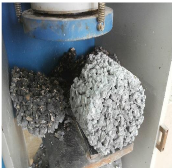
ب) آزمایش مقاومت کششی دو نیم شدن (مستقیم)
