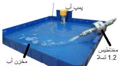
شکل ۳. دستگاه مغناطیس کردن آب: مخزن، پمپ و آهنربای ۱/۲ تسلا
