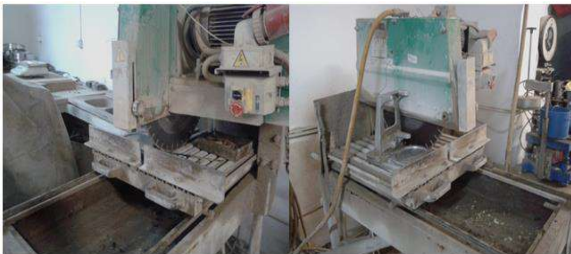
شکل ۱. دستگاه مورد استفاده برای برش نمونه‌ها
