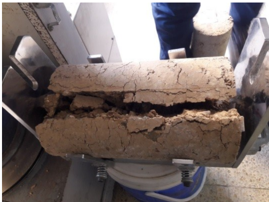
شکل ۱۰. نمونه استوانه‌ای پس انجام آزمایش کشش غیرمستقیم برزیلی
