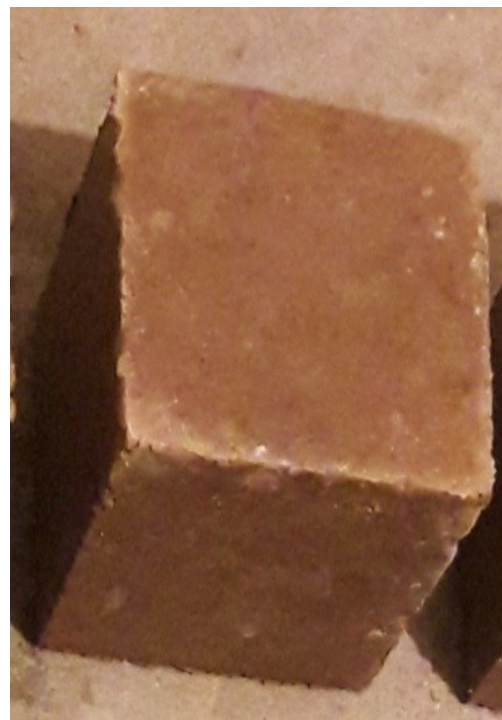
شکل ۶. نمونه ساخته شده با 9.09E-03 درصد RRP برای آزمایش در سن ۱۰ روز
