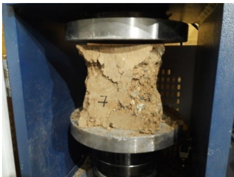
شکل ۸. نمونه مکعبی با 2.12E-02 درصد RRP پس از بارگذاری و شکستن آن
