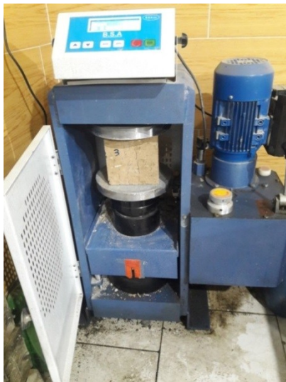
شکل ۷. دستگاه جک بتن شکن
