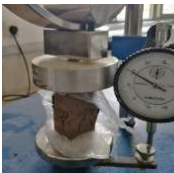
شکل ۱۵. یکی از نمونه‌های آزمایش دوام تحت بارگذاری منحنی تنش- کرنش در سیکل انجماد- ذوب، نمونه ترکیبی با ۱ درصد نانوسلولز، عمق ۲۰ س.م. گمانه A
