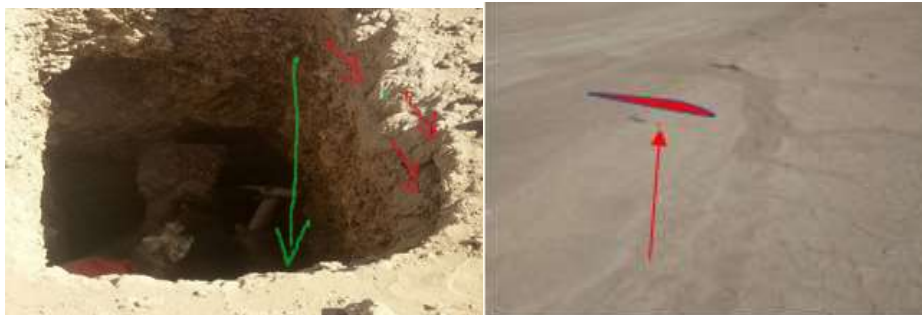
شکل ۱. تصویری از نواحی گسیخته شده در کناره‌ی مسیر عبور (بستر راه فرعی)- سمت راست و تصویری از یکی از گمانه‌های مورد برداشت- سمت چپ
