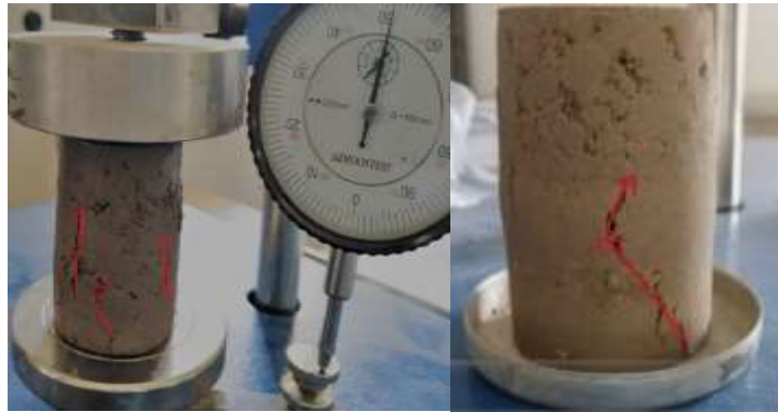
شکل ۱۲. گسترش ترک خوردگی دو نمونه تحت آزمایش تک محوری
