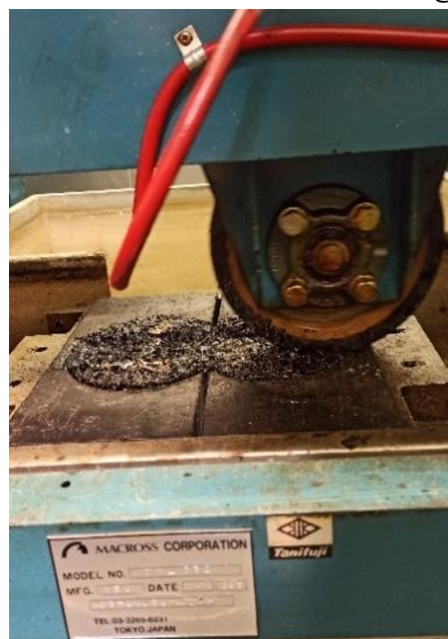
شکل ۵. بارگذاری چرخ هامبورگ روی نمونه های استوانه ای
