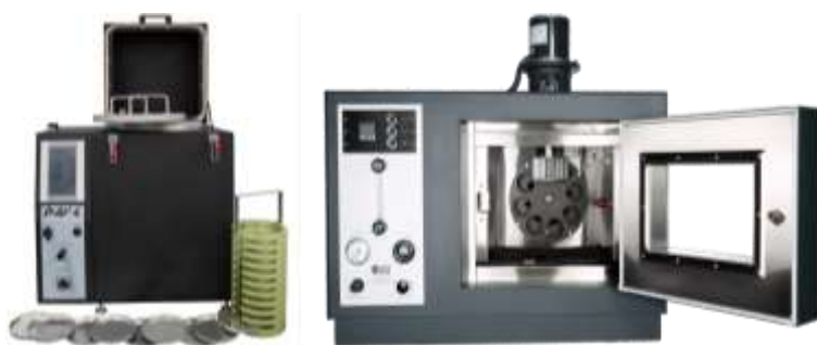
شکل ۲. سمت راست: دستگاه RTFO و سمت چپ: دستگاه PAV
