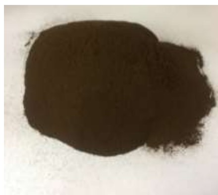
شکل ۱. لیگنین به‌دست آمده و عبوری از الک ۱۰۰
