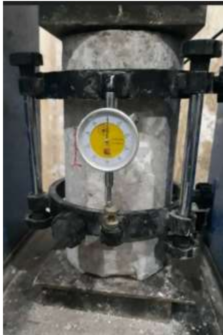
شکل ۲. نمونه بتنی در حال انجام آزمون مدول الاستیسیته
