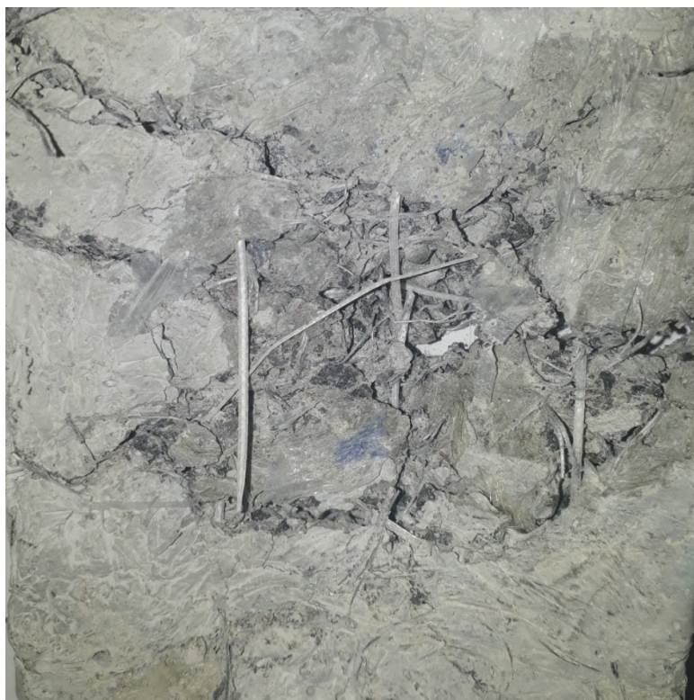
شکل ۷. سطح شکست نمونه بتنی تقویت‌شده با الیاف هیبریدی
