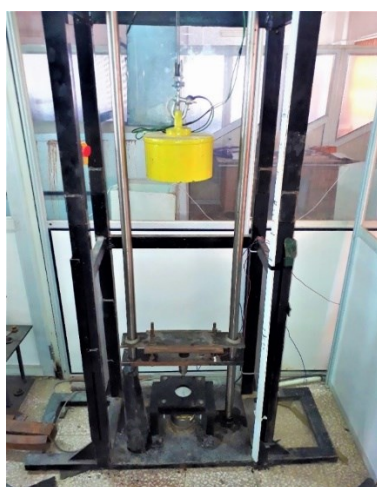
شکل ۳: دستگاه تست سقوط وزنه جهت آزمون ضربه نفوذی
