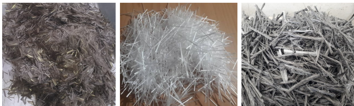
شکل ۱. الیاف استفاده شده در بتن تقویت‌شده: الف) فورتا، ب) بارچیپ و ج) بازالت
