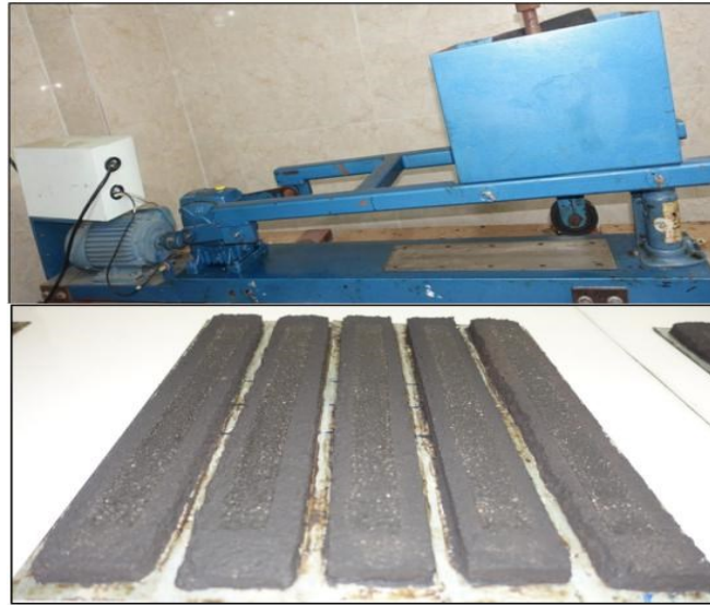
شکل ۵. دستگاه چرخ بارگذاری- ارزیابی جابه‌جایی و نمونه‌های آن
