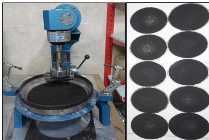
شکل ۴. نمایی از دستگاه آزمایش WTAT و نمونه‌های آن
