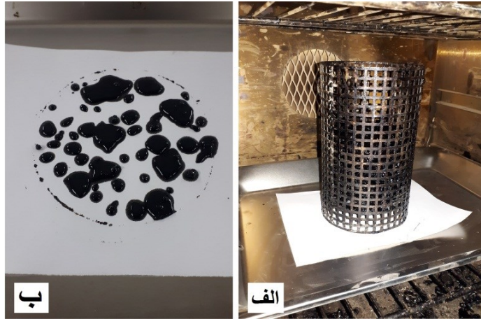
شکل ۴. تست ریزش قیر: الف) سبد ریزش قیر و ب) قیر ریخته شده
