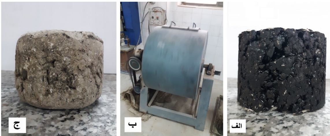
شکل ۵. تست کانتابرو: الف) نمونه تازه، ب) نمونه درون دستگاه لس آنجلس و ج) نمونه تست شده
