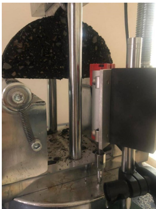
شکل ۶. دستگاه آزمایش شکست بر نمونه‌های خمشی نیم‌دایره‌ای
