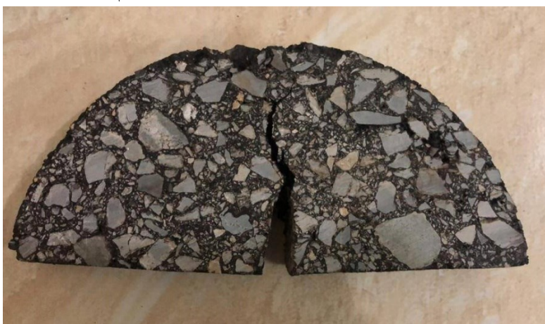
شکل ۷. نمونه مخلوط آسفالتی گرم پس از آزمایش شکست
