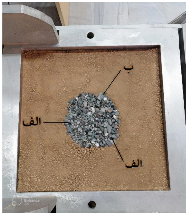
شکل ۳. نمونه ساخته‌شده برای حالت ستون سنگی منفرد با قطر ۱۱۰ میلی‌متر: الف) خرده لاستیک و ب) مصالح سنگی
