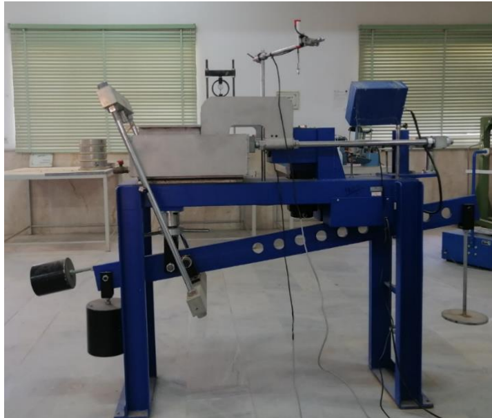
شکل ۴. دستگاه برش مستقیم بزرگ‌مقیاس
