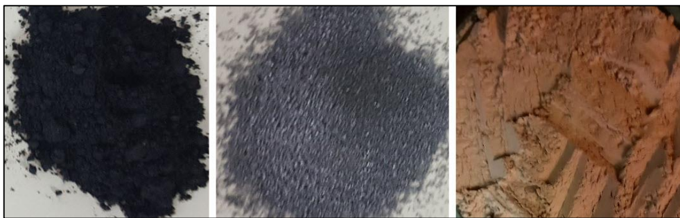
شکل ۱. وضعیت ظاهری انواع فیلرهای مصرفی: (الف) پودر سنگ، (ب) پودر آهن و (پ) پودر مگنتیت
