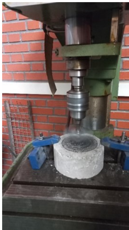
شکل ۷. دستگاه تست سایش (ASTMC944)
