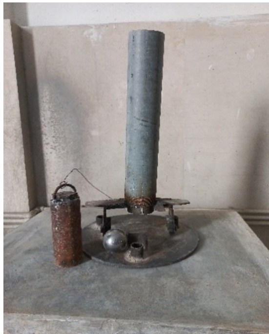
شکل ۹. دستگاه تست ضربه مطابق با استاندارد ACI544
