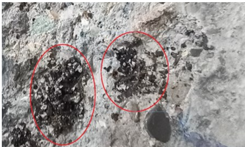
شکل ۱۴. نواحی ذوب شده از سطح نمونه طی عملیات سایش
