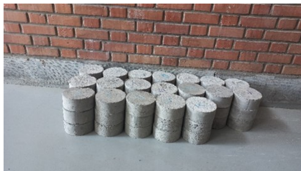
شکل ۶. نمونه‌های برش داده شده به منظور تست مقاومت در برابر سایش و ضربه
