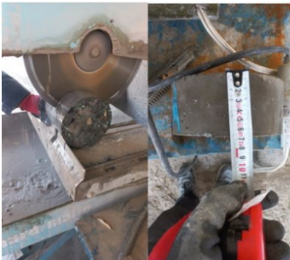
شکل ۵. برش نمونه‌های استوانه‌ای به ضخامت ۶/۴ سانتی متر
