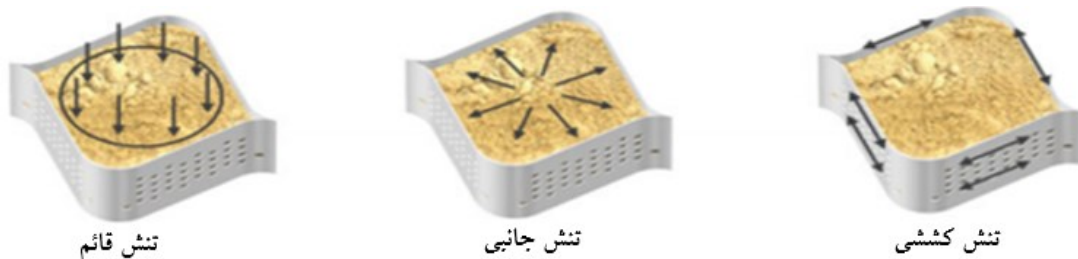
شکل ۷. مکانیزم رفتاری ژئوسل (سیتارام و همکاران، ۲۰۱۹)
